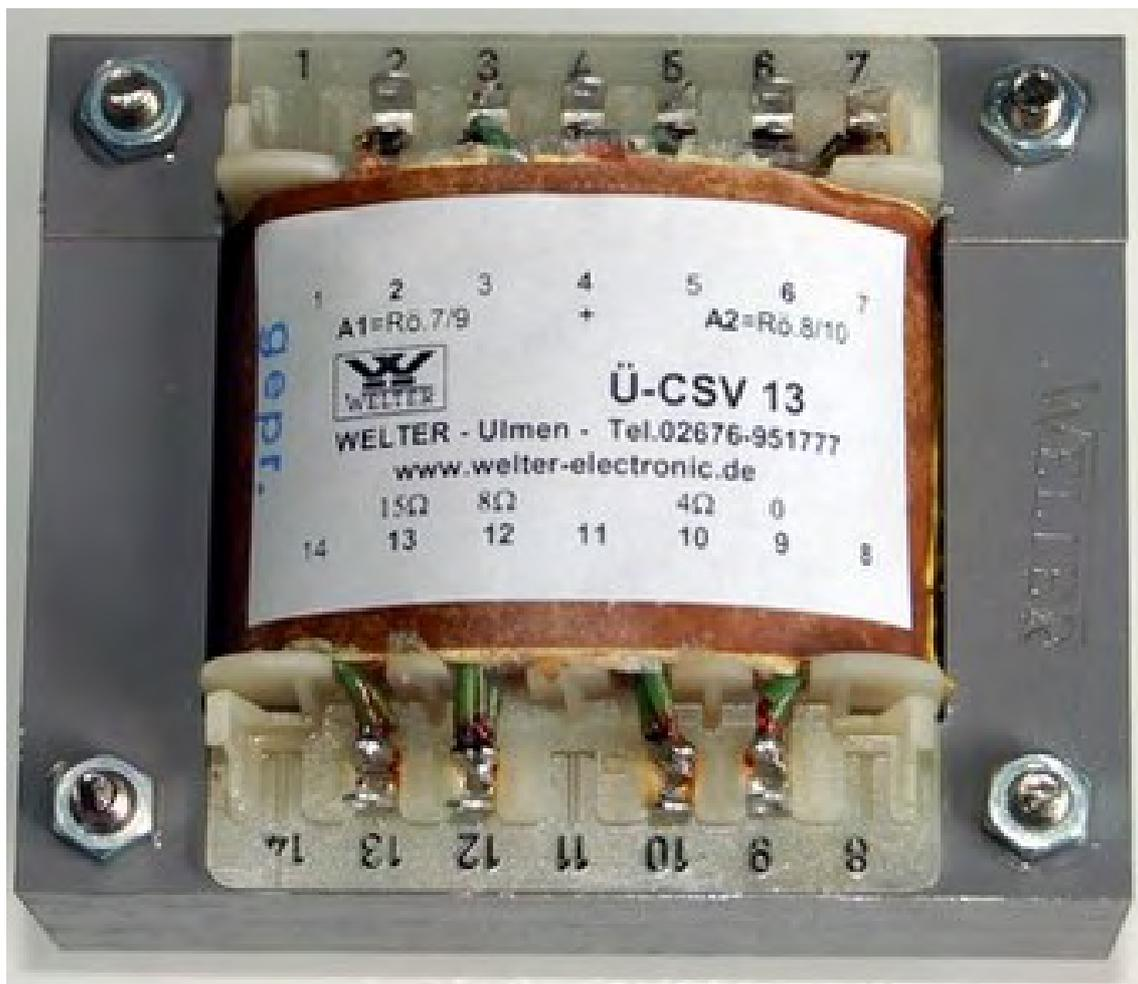
Abb. 9: Ausgangsübertrager der Firma Welter
